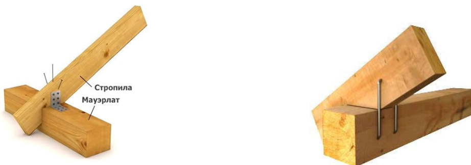
Рисунок 1 – Виды креплений стропилы к мауэрлату
